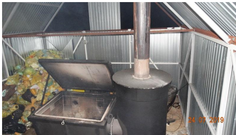
Рисунок 21. Установка по сжиганию медицинских отходов на полигоне ТКО Юрьянского района. Фото Д. Левашова, ЭкоСПС.
