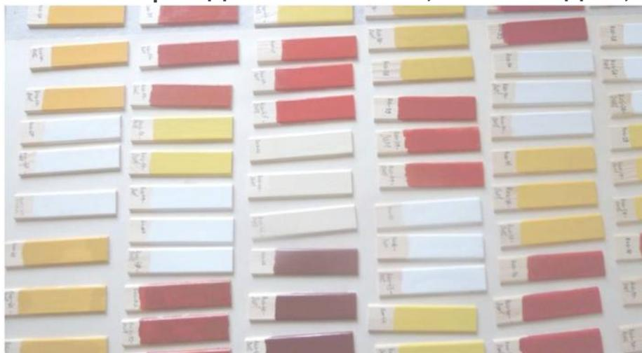
Пробы красок анализировали с применением метода ЕРА3050В/7420, т.е. с кислотным озолением проб для последующей пламенной атомно-абсорбционной спектроскопии
