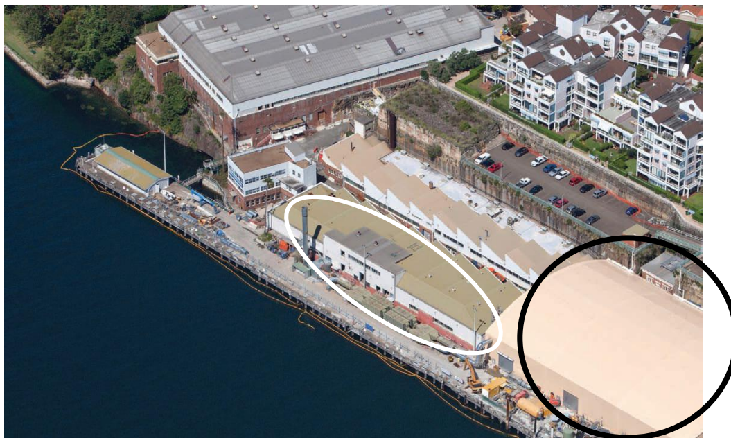
Рис. 7: Реабилитация с применением защитного сооружения и участок газоочистки Источник: Australian Federal Government (2013)
