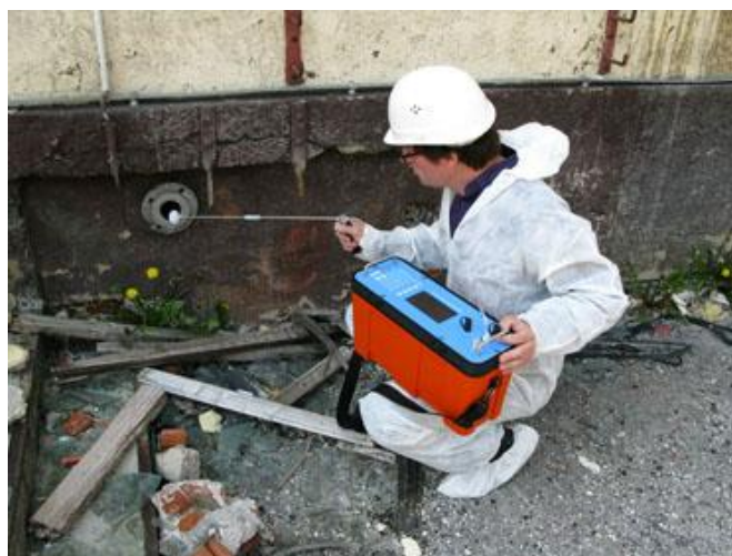
Рис. 1: Пример изучения загрязненного участка с использованием портативного анализатора ртутных паров.
